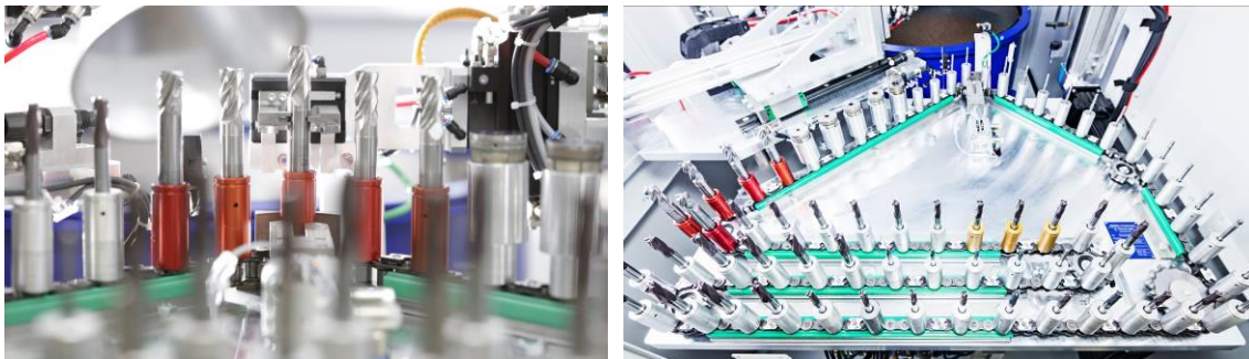
Troca automática de ferramenta com carregador tipo carrossel
